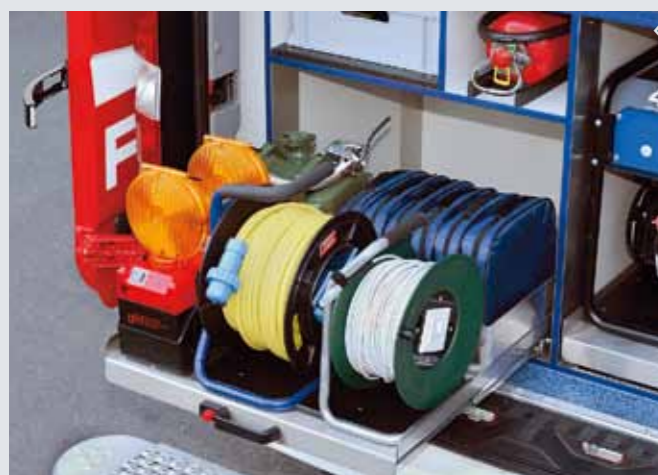
Blitzleuchten, Stromkabel, LAN-Kabel, sechs Faltsignale sowie zwei Reservekanister auf einem Auszug im Heck.
