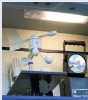
Die Wetterstation ist auf eine Platte montiert, die mit wenigen Handgriffen auf den Träger hinten auf dem Fahrzeugdach montiert werden kann.
