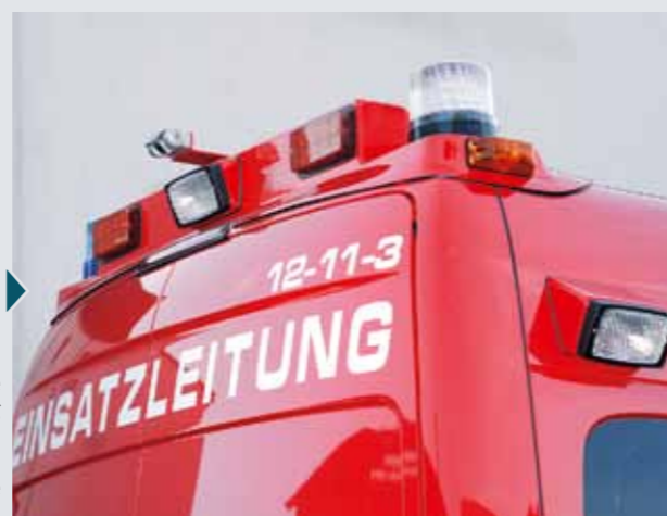
Der Heckbalken trägt Umfeldbeleuchtung, Heckblaulicht, Rotlicht für die Kennzeichnung der Einsatzleitung, Verkehrswarnanlage sowie Rückfahrkamera.
